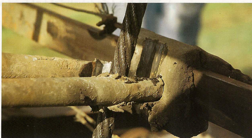
EN 19 MILLIMETER TJOCK vänstertvinnad stålvaajer håller upp bormejseln som vrids något för varje slag.
